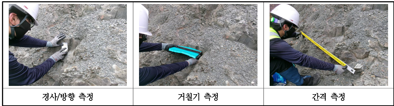
【사진 55.3.2】 불연속면 측정 현황
